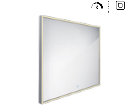
LED zrcadlo 700x700 S dotykovým senzorem. Příkon 32 W. Možnost nastavení teploty svítivosti od 2700 - 6000K. Rám hliníkový.
